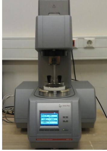
Şekil 1 Bu çalışmada kullanılan reometre, (Model: MCR 102, Anton Paar).
